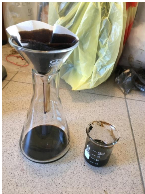
Рисунок 10 – Процесс фильтрования смеси нефтешлама и хлороформа
