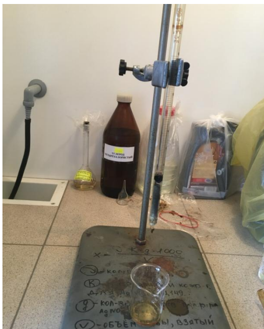
Рисунок 11 – Хроматографическая колонка для проведения анализа на содержание нефтепродуктов в нефтешламе
