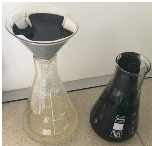
Рисунок 7 – Процесс фильтрования смеси нефтешлама и толуола
