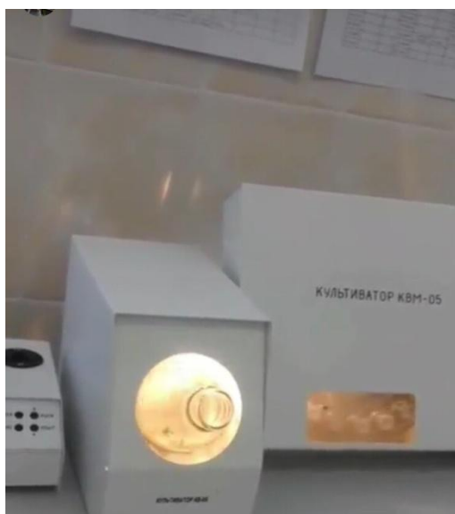
Рисунок 13 – Проведение биотестирования на хлорелле в культиваторе
