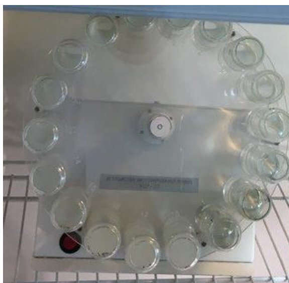
Рисунок 12 – Проведение биотестирования на дафниях в УЭР - 03
