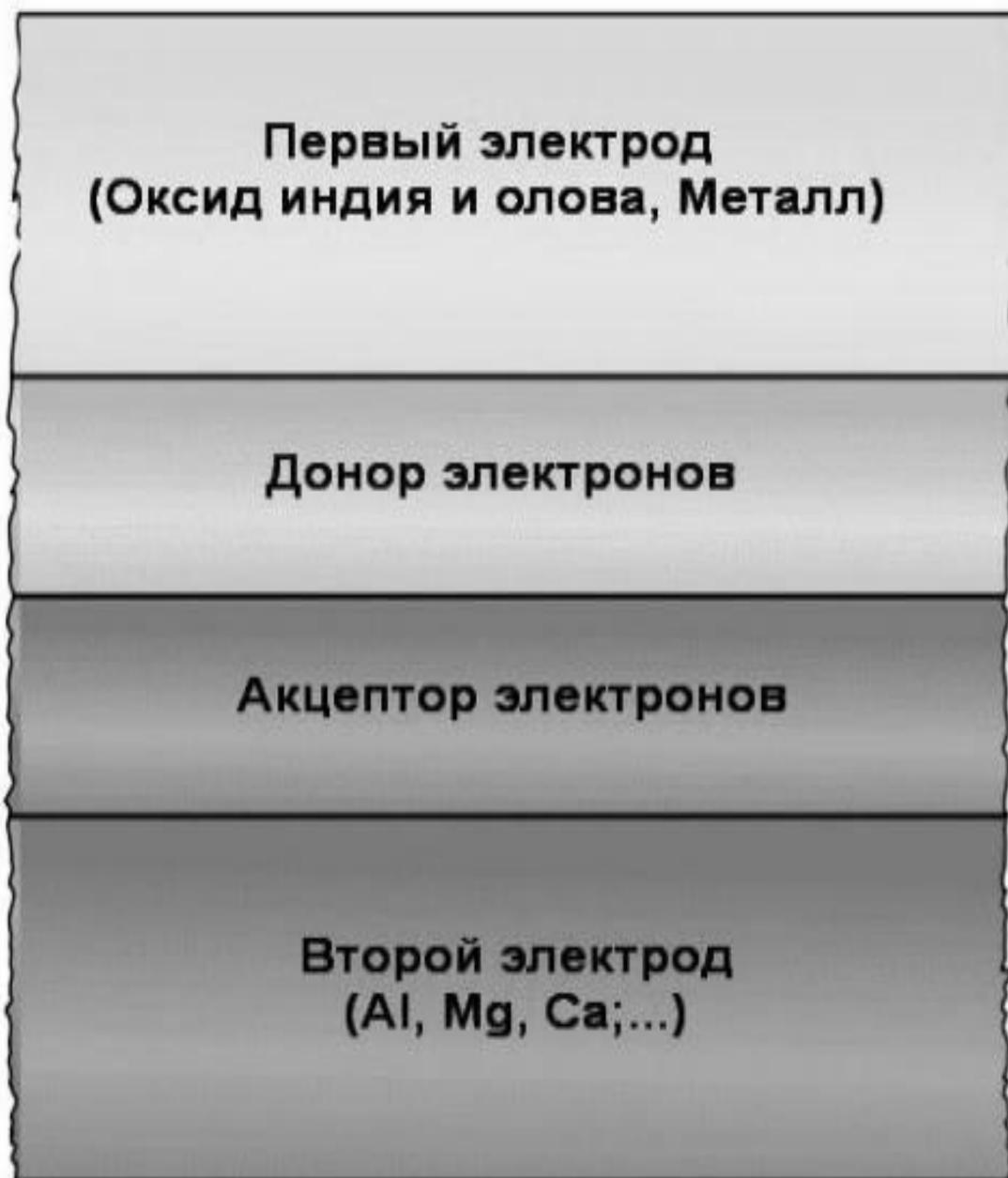
Рисунок 6 – Структура полимерного солнечного элемента
