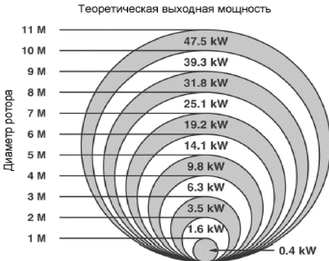
Рисунок 22 – Зависимость мощности ветряков от диаметра роторов и площади лопастей
