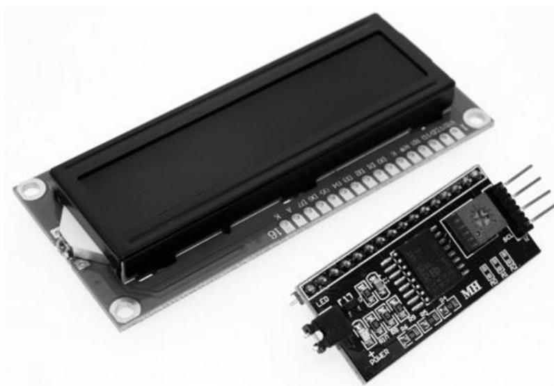
Рисунок 31 – Изображение жидкокристаллического дисплея LCD1602, подключаемого через плату расширения I2C-интерфейса
