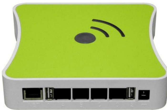
Рисунок 15 - Центральный управляющий контроллер «Z-wave Plus», используемый в системе Z-wave
