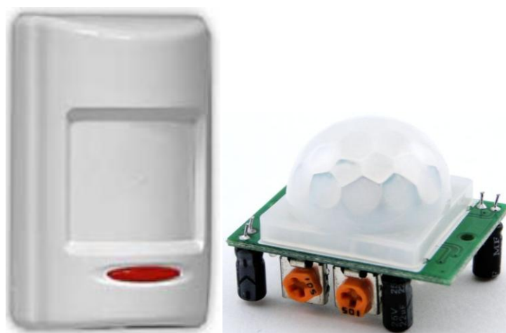
Рисунок 20 - Датчик движения и его аналог на базе Ардуино
