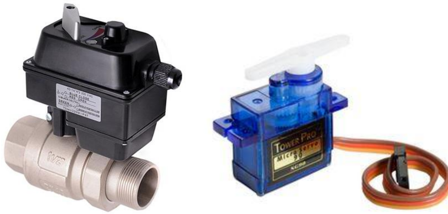
Рисунок 22 - сервопривод, применяющийся в системах умный дом и его аналог на базе Ардуино
