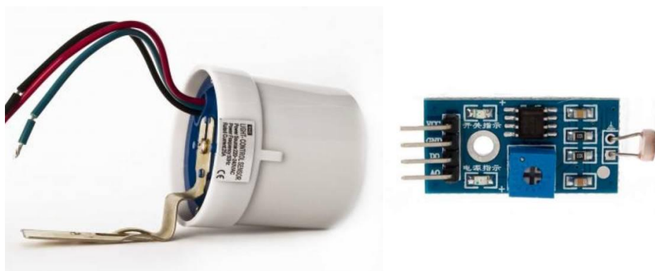
Рисунок 19 - Датчик освещенности и его аналог на базе Ардуино
