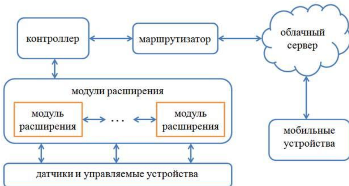
Рисунок 10 - Графическое изображение облачной архитектуры управления
