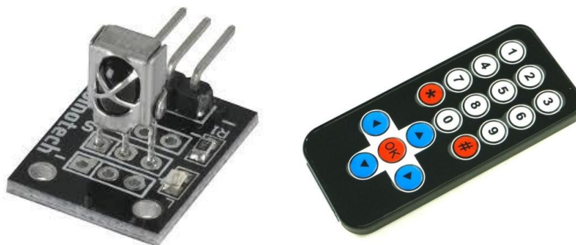
Рисунок 29 – IR модуль и пульт управления инфракрасного модуля
