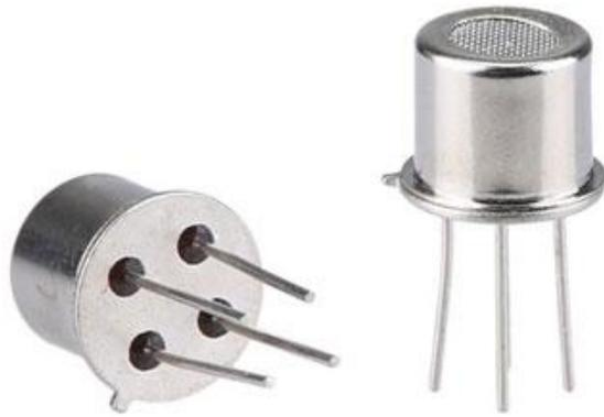
Рисунок 4.3. – Внешний вид датчика MG812
