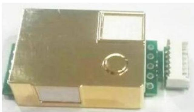
Рисунок 4.6. – Внешний вид датчика MH-Z19B.
