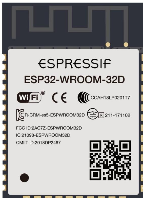
Рисунок 4.16. – Внешний вид модуля ESP32-WROOM-32D
