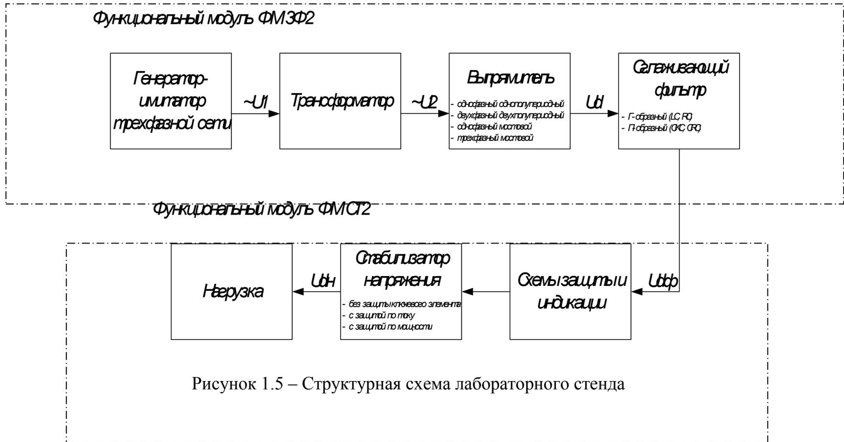
Рисунок 1.5 – Структурная схема лабораторного стенда
