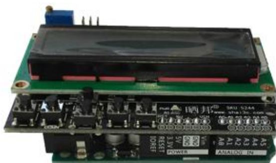
Рисунок 24 – Подключение LCD Keypad shield к Arduino Uno.
