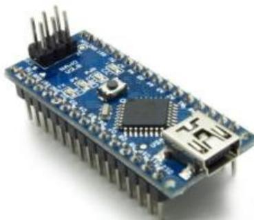
Рисунок 15 - Плата Arduino Nano 3.0
