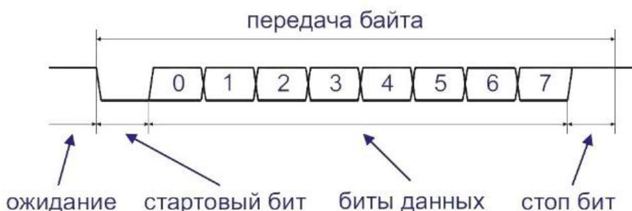
Рисунок 20 - Последовательная передача данных
