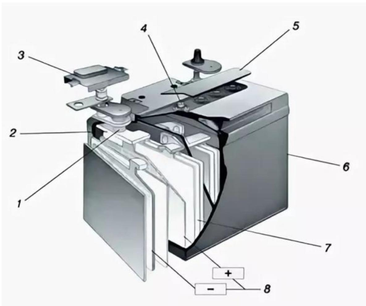
Рисунок 1.4.2 – конструктивная схема AGM аккумуляторной батареи: 1 – уплотнительное кольцо вывода; 2 – положительный вывод; 3 – изолирующая крышка; 4 – клапан избыточного давления; 5 – крышка клапанов; 6 – корпус; 7 – стекловолоконный сепаратор; 8 – положительные и отрицательные пластины.
