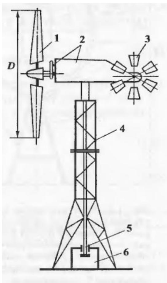
Рисунок 1.2.1 – конструктивная схема ВЭУ с горизонтальной осью вращения: 1 – рабочая лопасть; 2 – трансмиссия; 3 – виндроза; 4 – вышка (мачта); 5 – вал мощности; 6 – генератор
