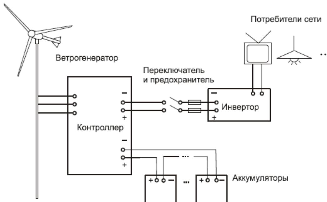
Рисунок 2.1.1 – структурная схема автономной системы электроснабжения.
