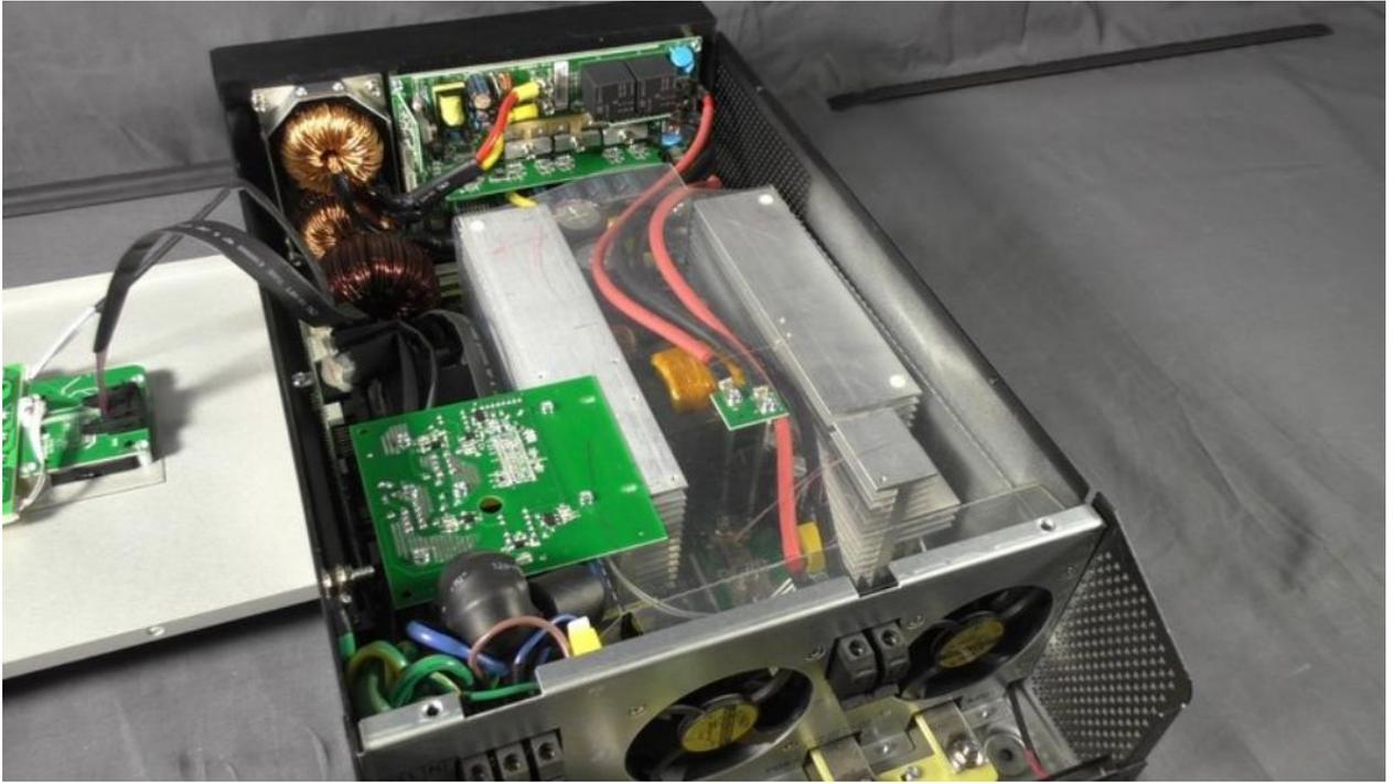
Рисунок 1.5.1- внутреннее устройство высокочастотного инвертора.
