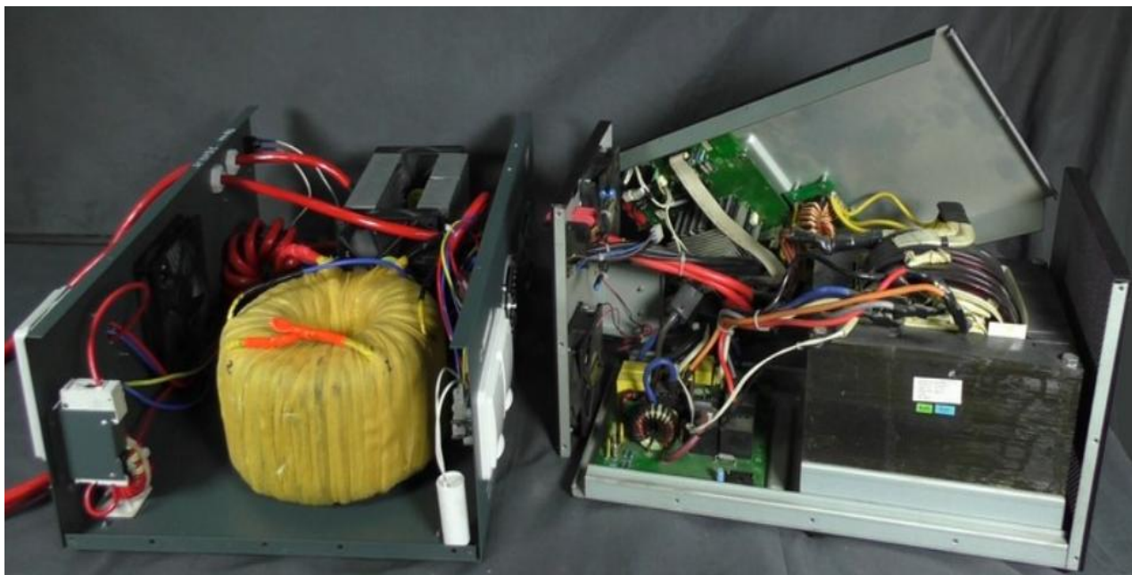
Рисунок 1.5.2 – внутренне устройство низкочастотных инверторов с тороидальным и броневым трансформаторами.
