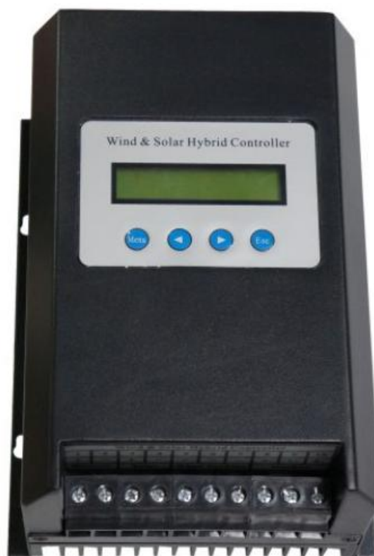
Рисунок 1.3.3- гибридный котроллер заряда АКБ
