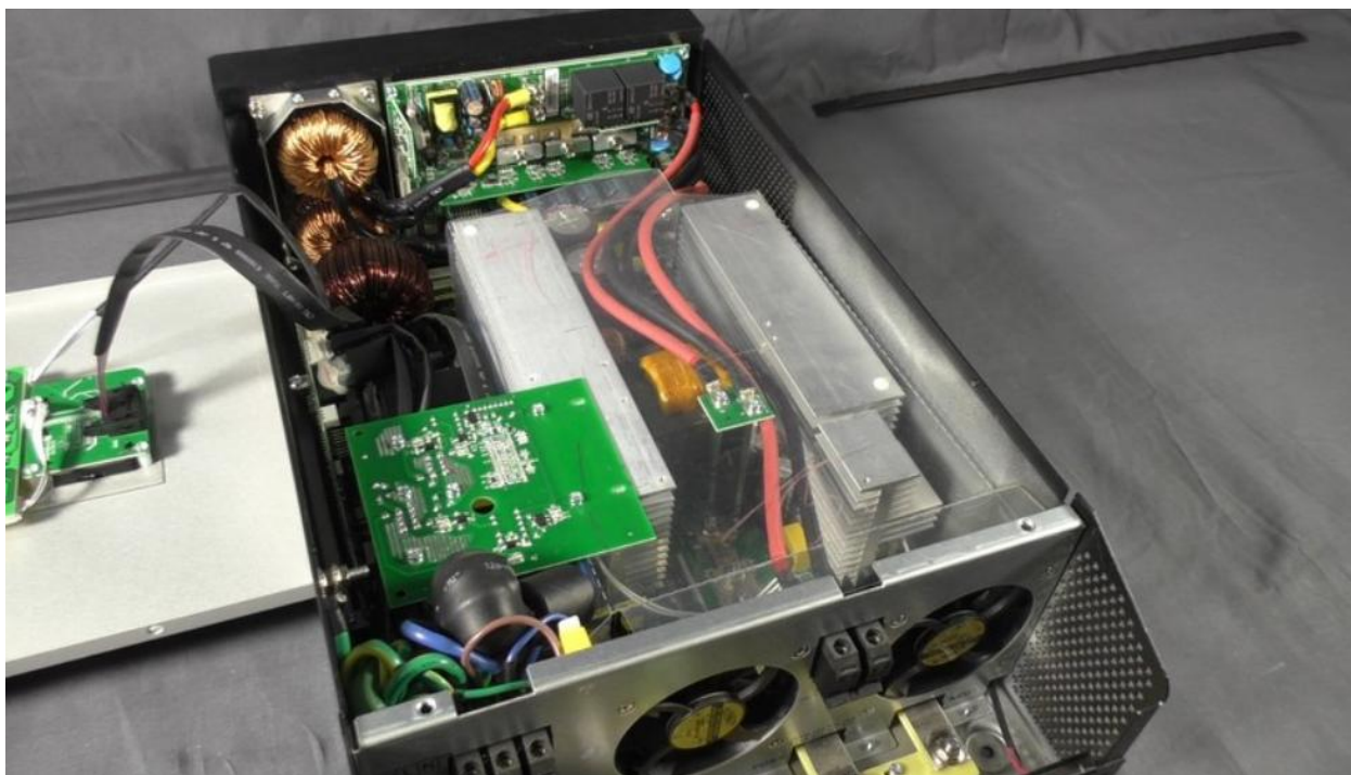
Рисунок 1.5.1- внутреннее устройство высокочастотного инвертора.
