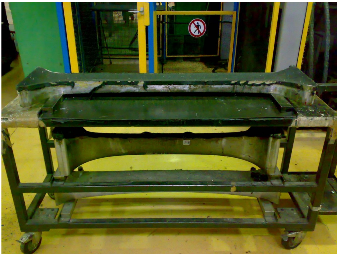
Рисунок 2.1 – Тележка для перемещения изделий
