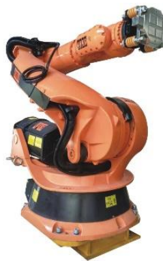
Рисунок 1.8. Манипулятор с магнитным захватом
