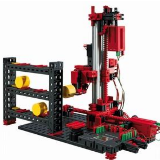
Рисунок 1.11 Манипулятор с вилочным захватом ROBO
