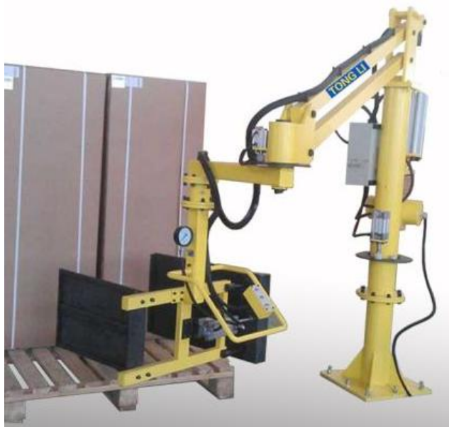
Рисунок 1.9. Манипулятор с вилочным захватом
