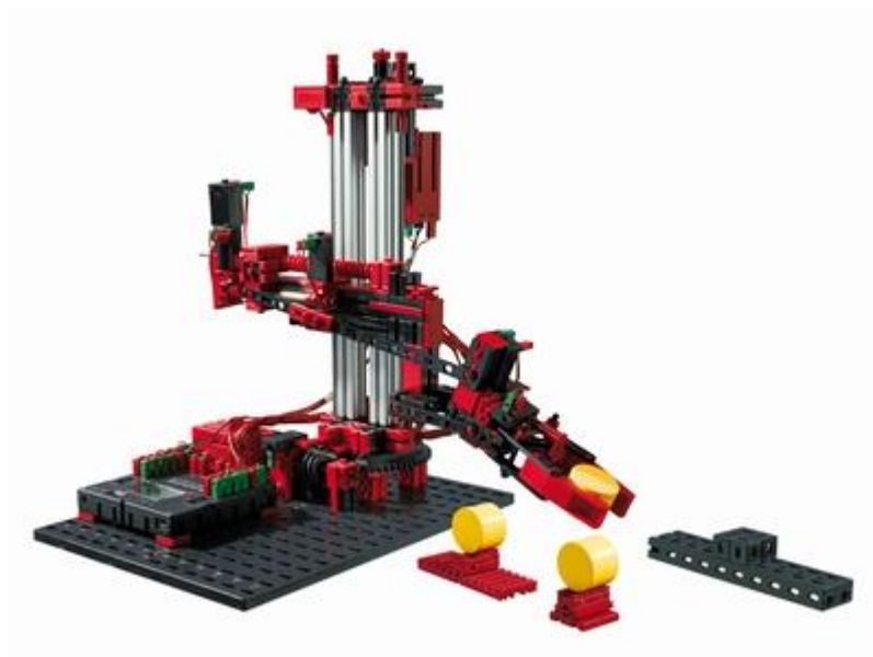
Рисунок 1.12. Манипулятор с клещевым захватом ROBO
