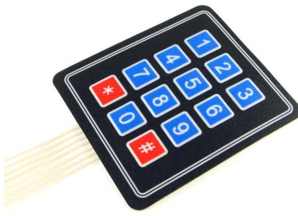
Рисунок 21 – матричная гибкая клавиатура
