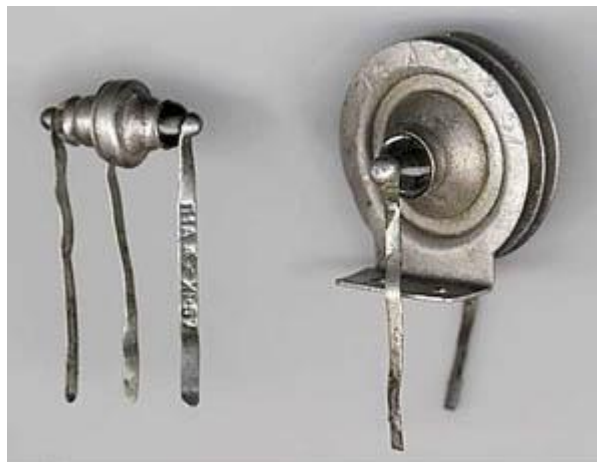
Рисунок 5 – первые отечественные транзисторы
