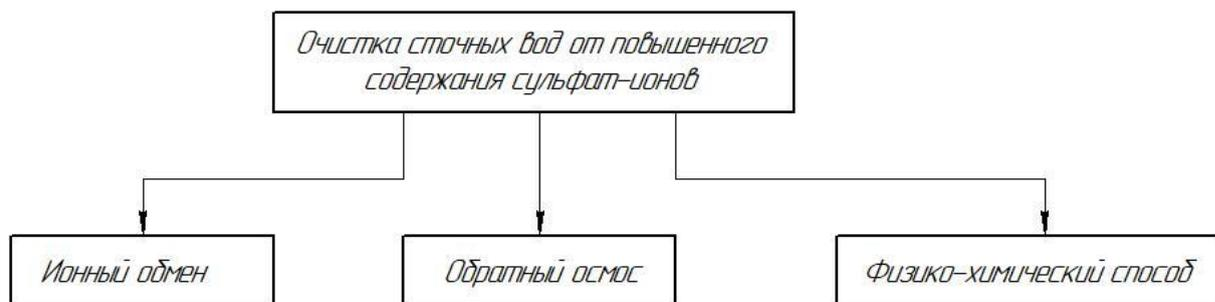
Рисунок 4 – Схема технологий снижения содержания сульфат-ионов в сточных водах
