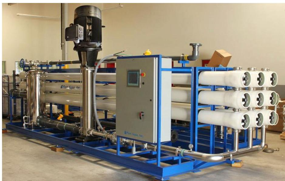
Рисунок 8 – Внешний вид промышленной установки обратного осмоса
