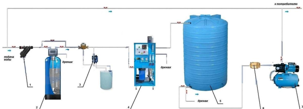
1 - фильтр предварительной очистки, 2 - сорбционный фильтр колонного типа, 3 - система дозирования антискаланта, 4 - система обратного осмоса, 5 - накопительная емкость, 6 - обратный клапан, 7 - повысительный насос
