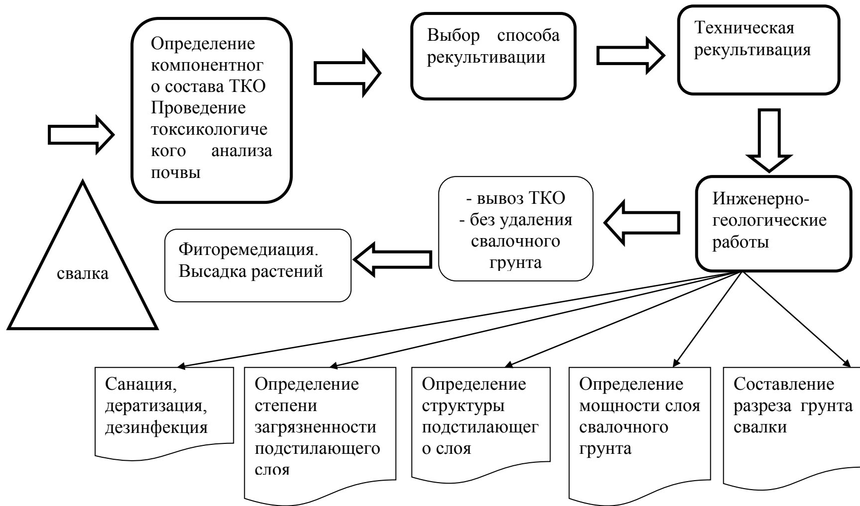
Рисунок 14 – Этапы рекультивации территории несанкционированной свалки
