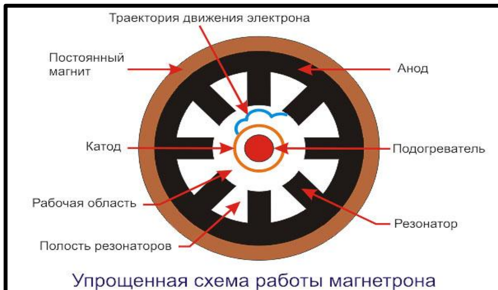
Рисунок 24 - Упрощённая схема работы магнетрона
