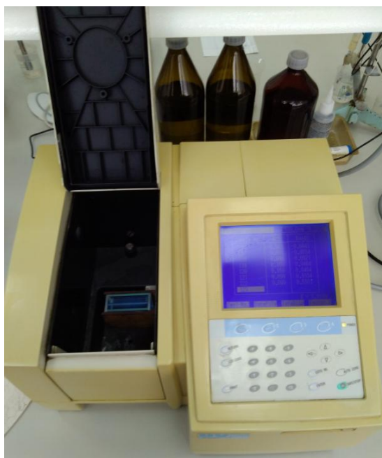
Рисунок 3.15 - Прибор- спектрофотометр SHIMADZU UV1240
