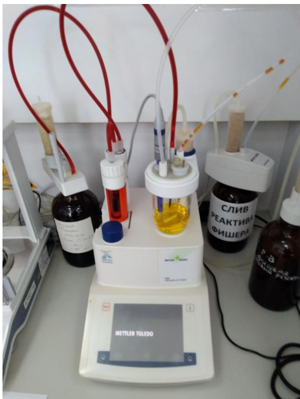
Рисунок 3.14 - Прибор- титратор по методу К. Фишера V20
