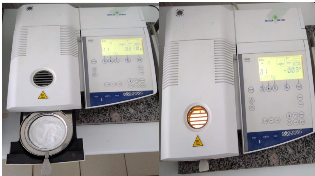
Рисунок 3.13 – Прибор - анализатор влажности (влагомер) HG63
