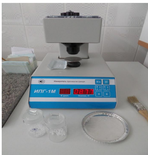
Рисунок 3.12 - Прибор-измеритель прочности гранул ИПГ-1М
