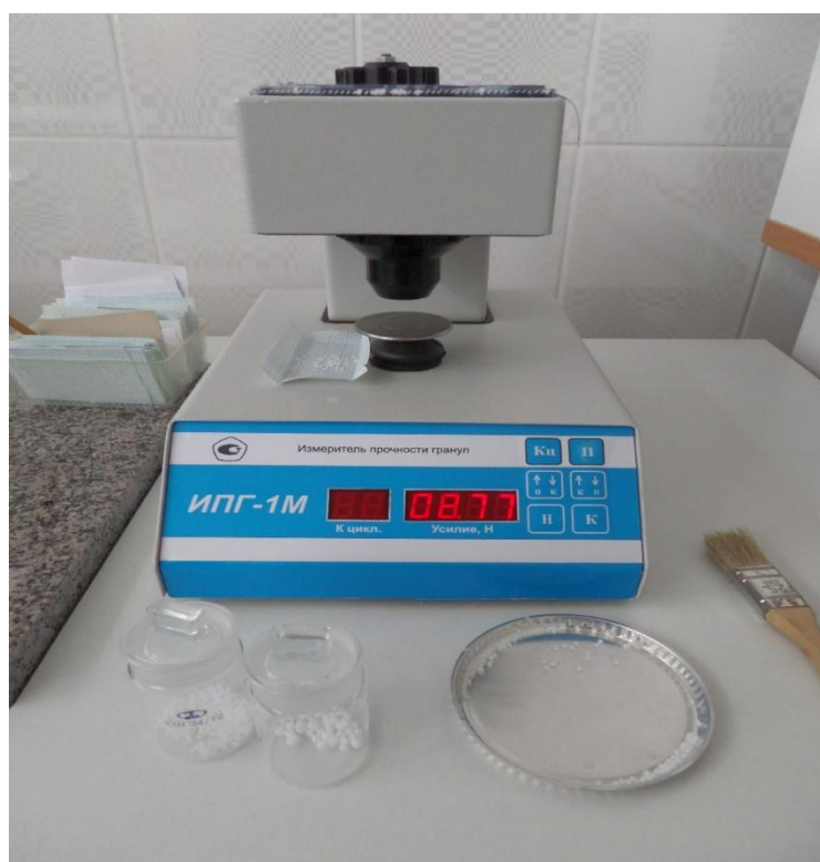
Рисунок 3.3 - Прибор-измеритель прочности гранул ИПГ-1М
