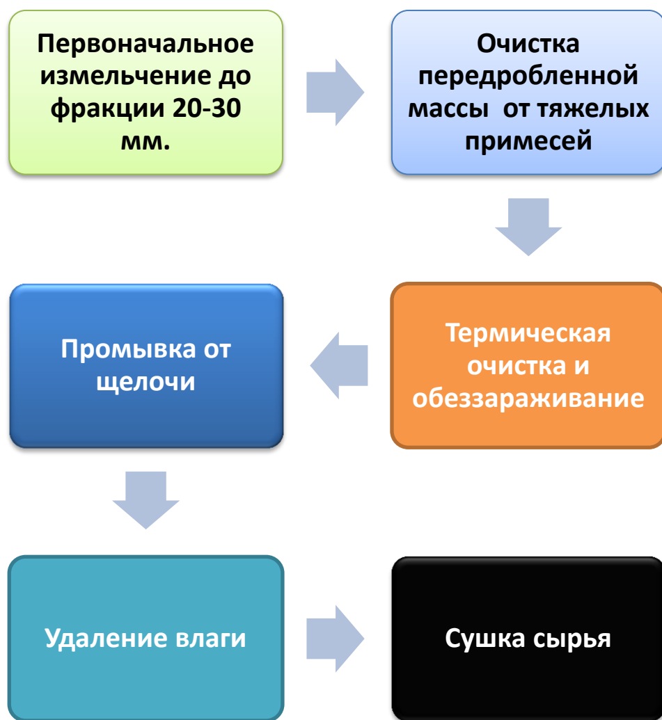
Рисунок 9 -Технологическая схема переработки ПЭТ
