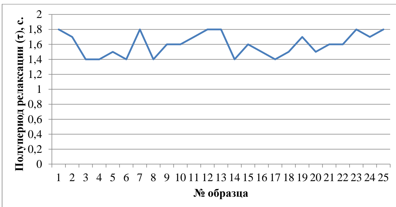
Рисунок 3 - график изменение значения параметра «Полупериод релаксации» для каучука марки СКМС-30АРКМ-15, выпущенного в течение первого полугодия 2017г.
