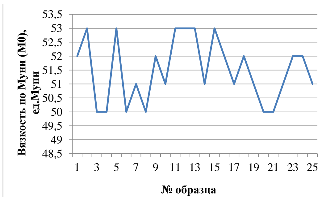
Рисунок 2 – график изменения значения параметра «Вязкость по Муни» для каучука марки СКМС-30АРКМ-15, выпущенного в течение первого полугодия 2017г.
