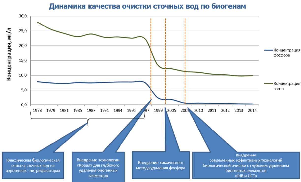
Рисунок 7 – Результаты модернизации очистных сооружений ГУП «Водоканал Санкт-Петербурга»
