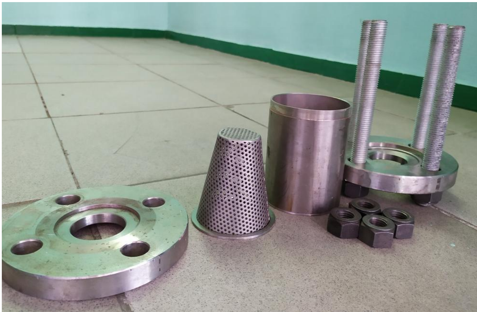
Рисунок 5 – Фильтр в разборе, вид сбоку
