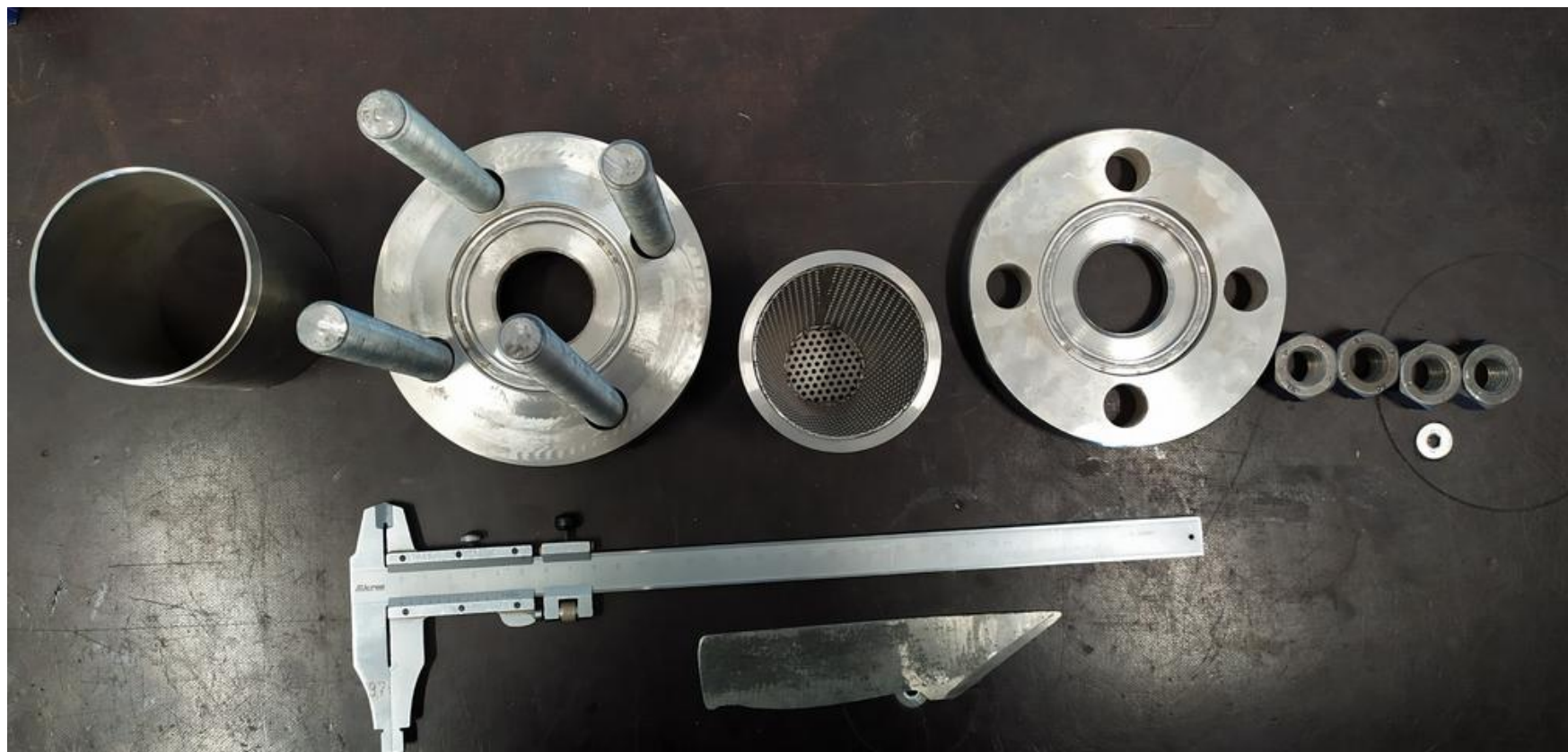
Рисунок 6 – Фильтр в разборе, вид сверху
