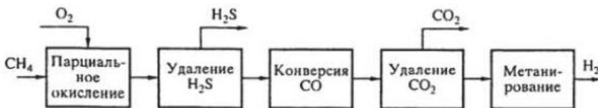
Рисунок 1. Схема процесса образования синтез-газа некаталитическим методом.
