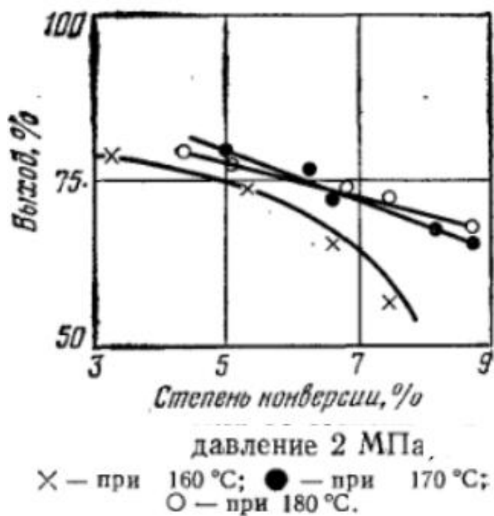
Рисунок 1.3 – Зависимость выхода спирта и кетона от температуры процесса окисления
