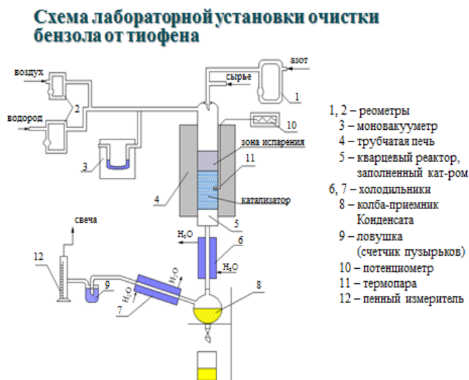
Рисунок 3.1 Схема лабораторной установки очистки бензола от тиофена
