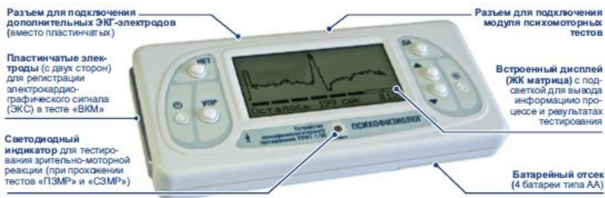
Рисунок Р.1 – Прибор УПФТ-1/30 «Психофизиолог» для организации предсменного контроля работников
