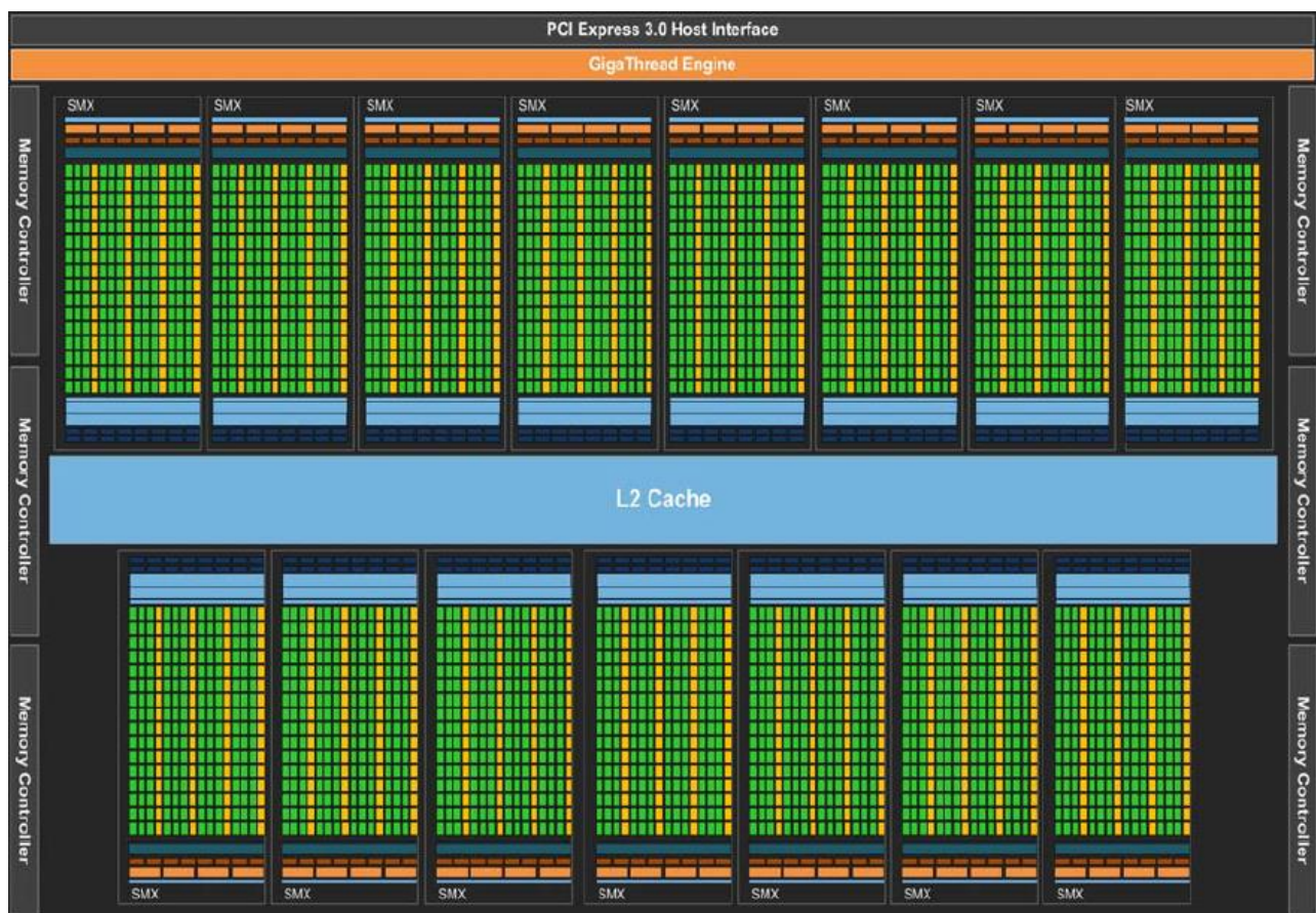
Рисунок 1.2 – Кластеры SMX в архитектуре Kepler
