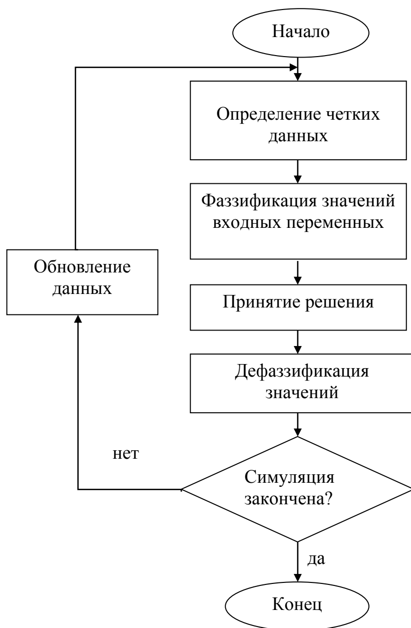
Рисунок 2.2 — Блок-схема этапов управления транспортным потоком
