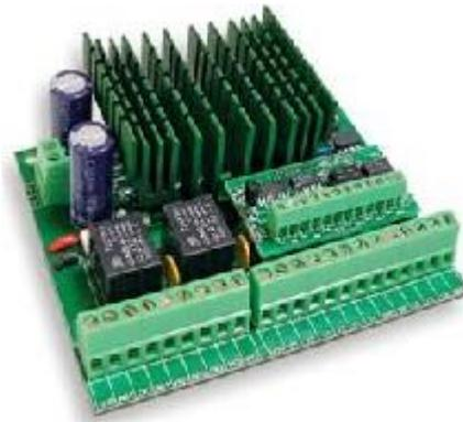
Рисунок 1.2 – Плата контроллера управления лифтом Октаграм L5L32
