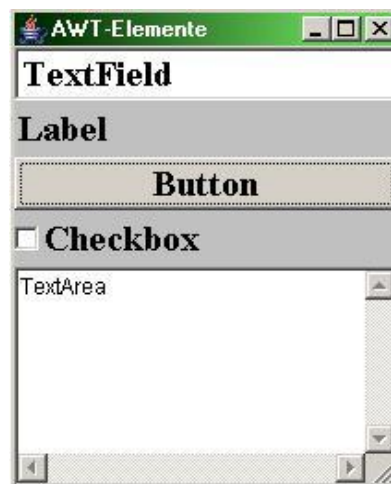
Рисунок 3.24 – Образец программы, написанной с использованием AWT в среде Windows
