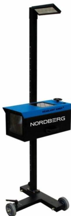
Рисунок 2.5 – Контрольный прибор для проверки параметров светораспределения фар автомобилей HLT610
