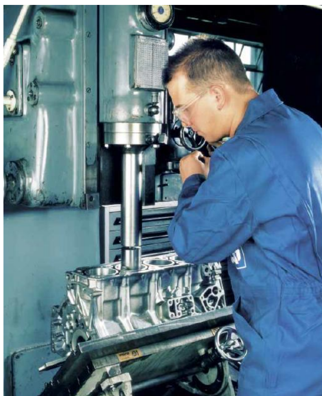
Рисунок 2.1 – Расточка цилиндров двигателя LADA Kalina
