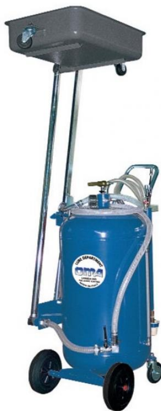
Рисунок 2.1 - Установка для слива отработанного масла 80л ОМА
