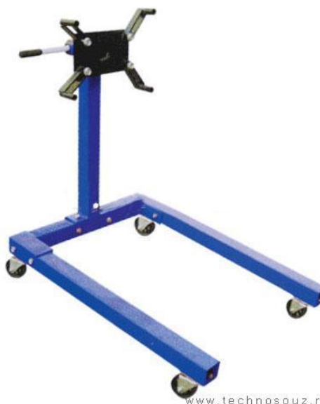
Рисунок 2.4 – Кантователь для раз- борки-сборки и ремонта ДВС модель T23401
