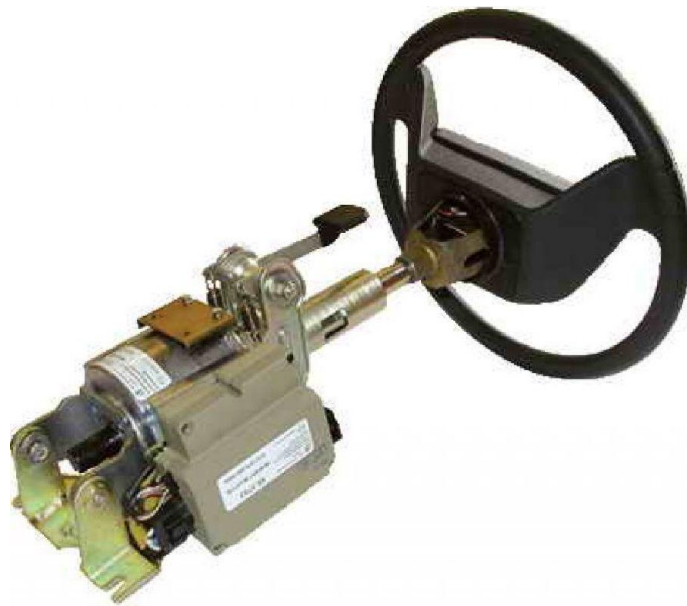
Рисунок 4 – Вариант компоновки безредукторного ЭУР на рулевой колонке с регулируемым положением руля по высоте
