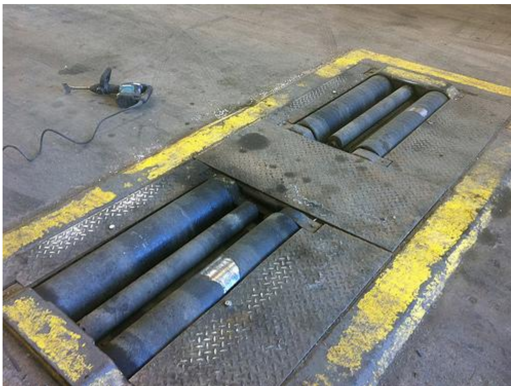
Рисунок 2.1 – Типовая конструкция роликового стенда
