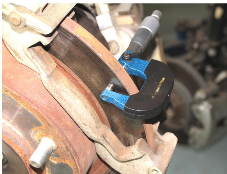
Рисунок 3.2 – Процедура проверки толщины диска измерительным инструментом
