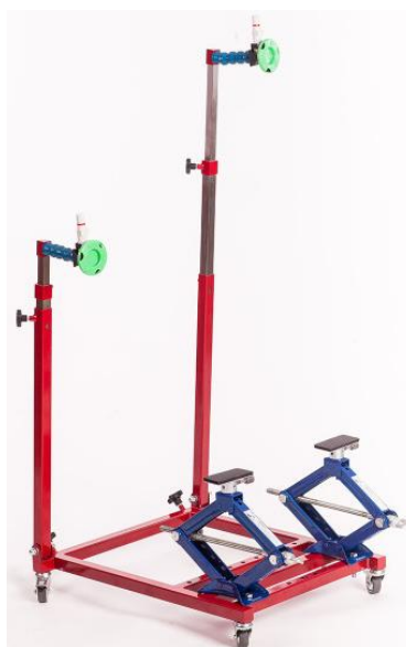
Рисунок 1.3 – Устройство для демонтажа и установки дверей автомобиля Filatris
