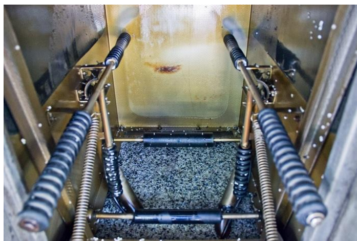
Рисунок 2.2- Общий вид рабочей камеры мойки колес
