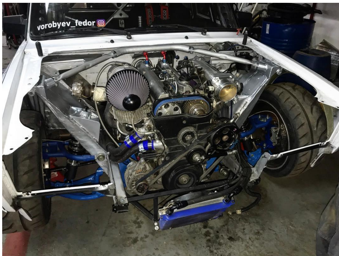
Рисунок 3.2 – Замена двигателя на дрефт-каре ВАЗ-2105.
