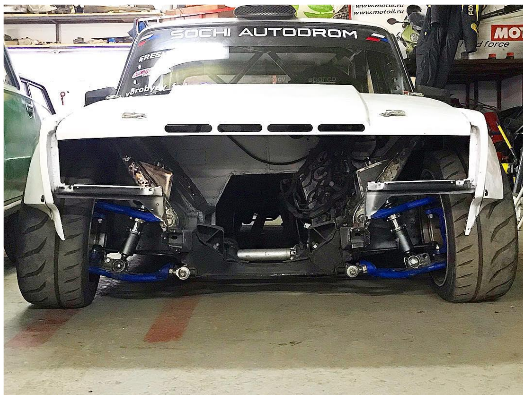
Рисунок 3.3 – Модернизация подвески ВАЗ-2105.
