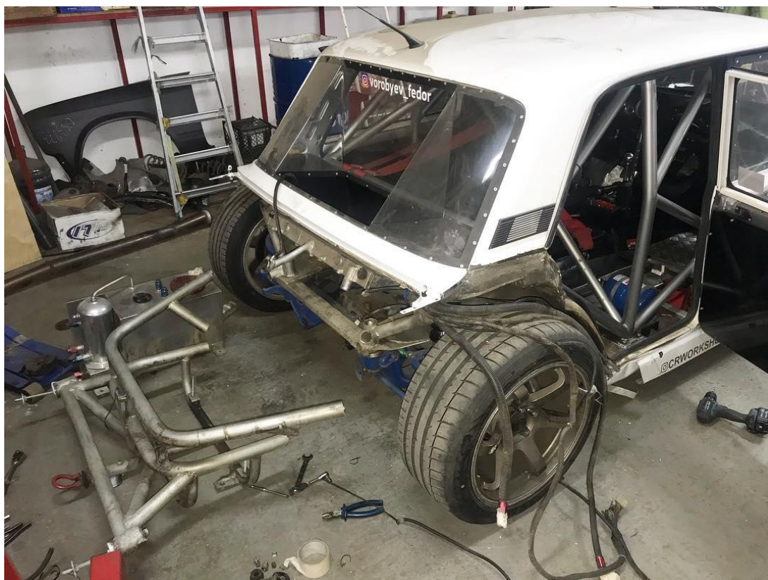
Рисунок 2.6 – Установка каркаса безопасности на ВАЗ-2105.
