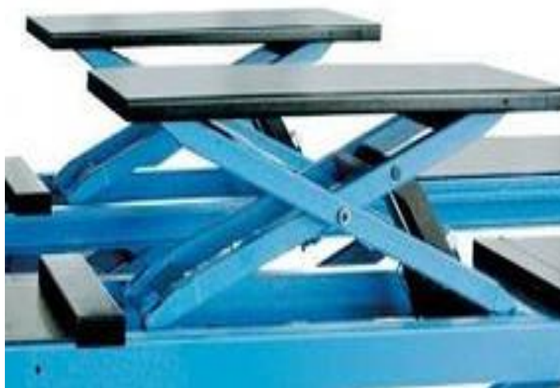
Рисунок 2.6 – Ножничный привод подъемника
