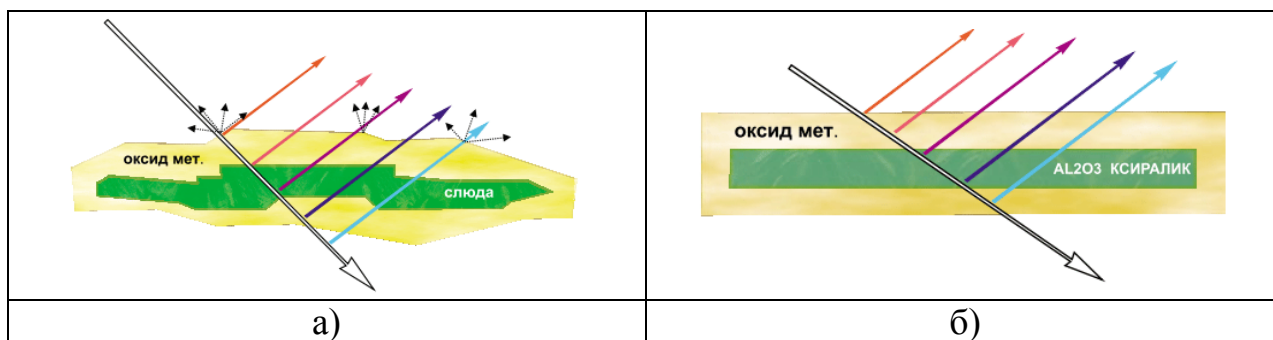
Рисунок 2.11 – Преломление света натуральным пигментом «перламутр» на основе натурального (а) и синтетического (б) носителя
