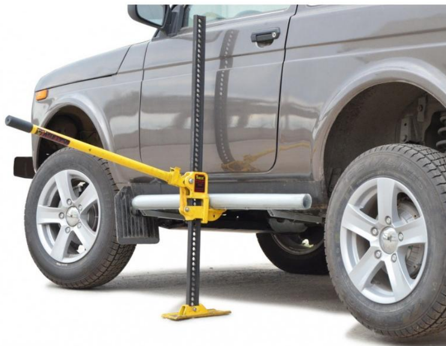
Рисунок 2.5 – Усиление порогов автомобиля ВАЗ-2121
