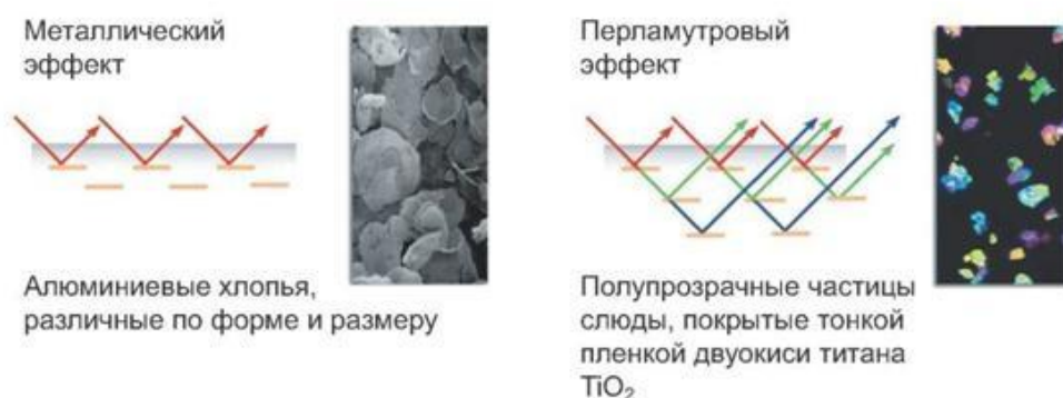
Рисунок 2.10 – Структура покрытия с эффектами «металлик» и «перламутр»
