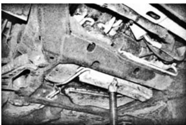
Рисунок 3.1 – Дополнительный упор с винтовым механизмом.
