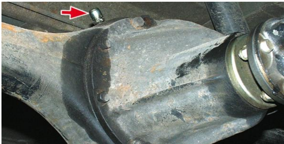
Рисунок 3.38 – Подтеки масла из редуктора
