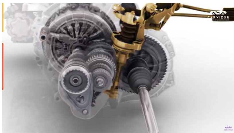
Рисунок 3.10 – Механизм выбора передач в ручном режиме
