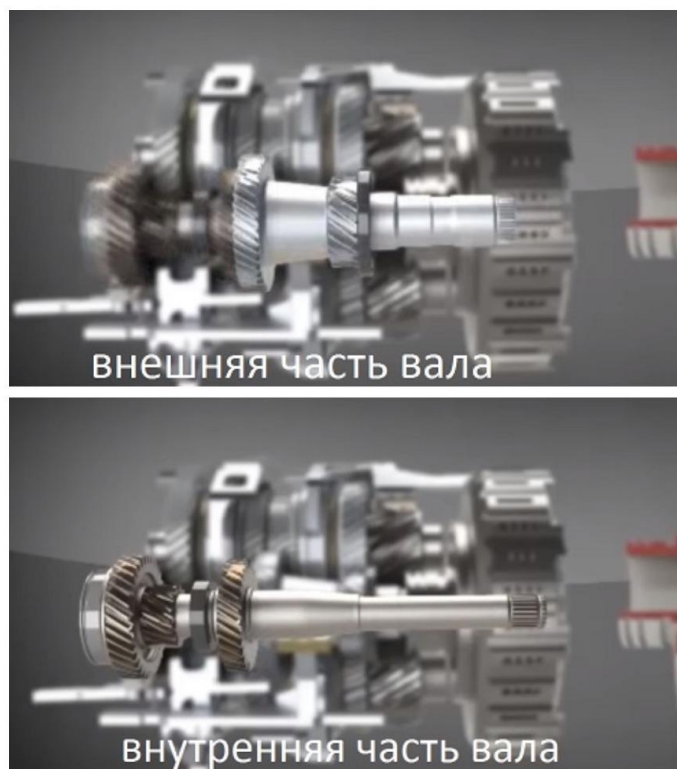
Рисунок 3.13 - Устройство двойного вторичного вала
