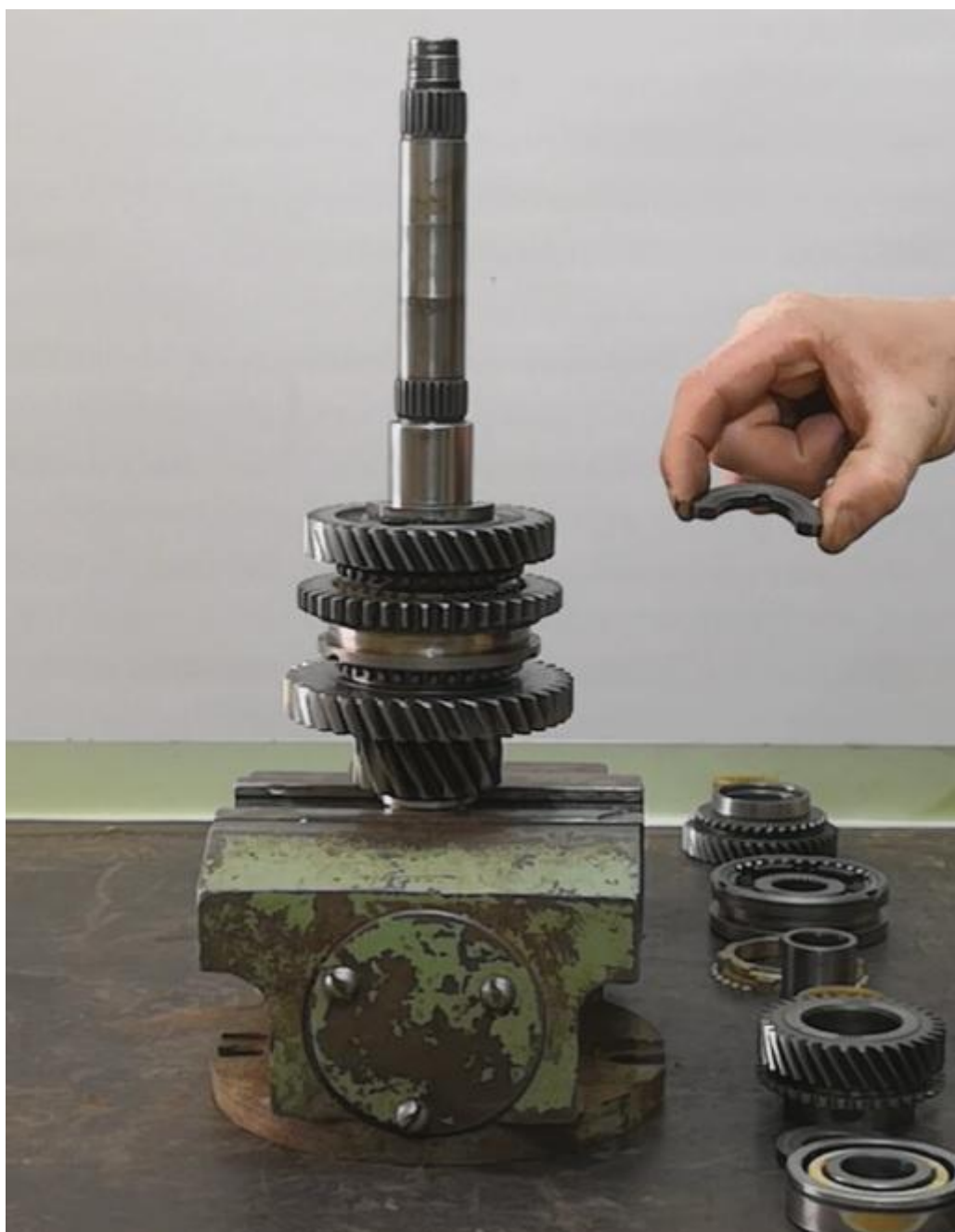
Видео 6.5 - Сборка вторичного вала без фиксирующего шарика
