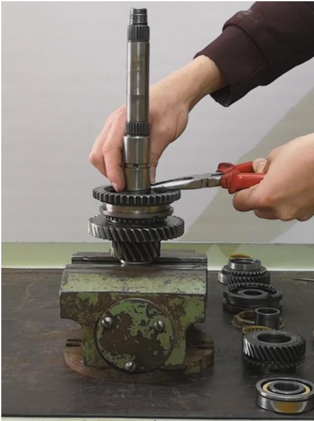
Видео 6.4 - Ошибка при установке шестерни задней передачи Сборка вторичного вала без фиксирующего шарика (видео 6.5).
