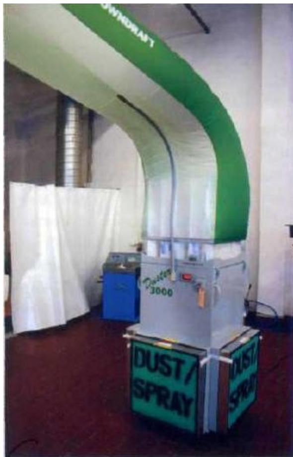
Рисунок 2 - Мобильный пост подготовки к покраске
