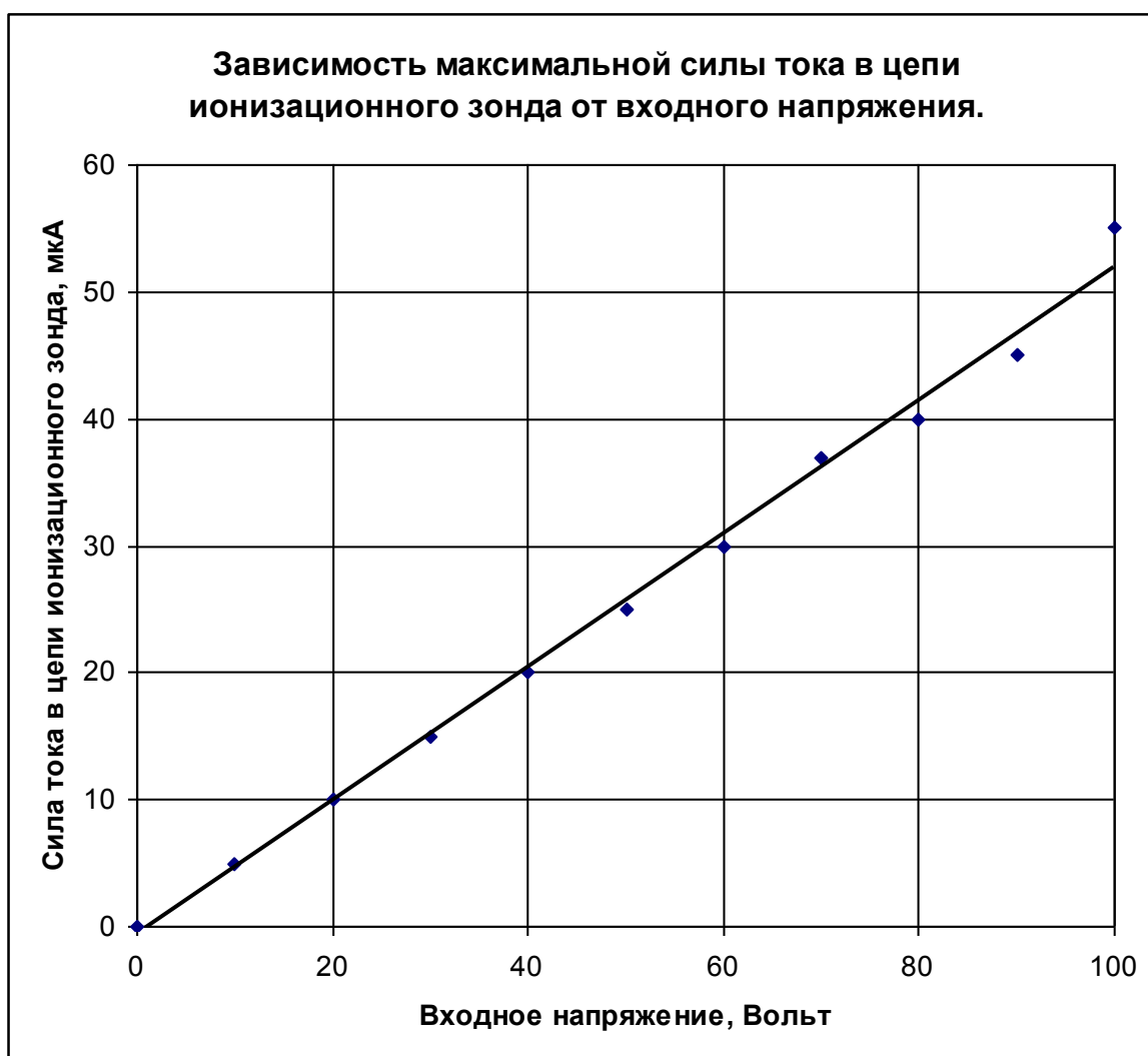
Рисунок 2.9 – Характеристика цепи ионизационного зонда
