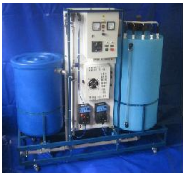
Рисунок 1.1 – Электролизер для получения водорода из воды, методом электрохимического разложения.
