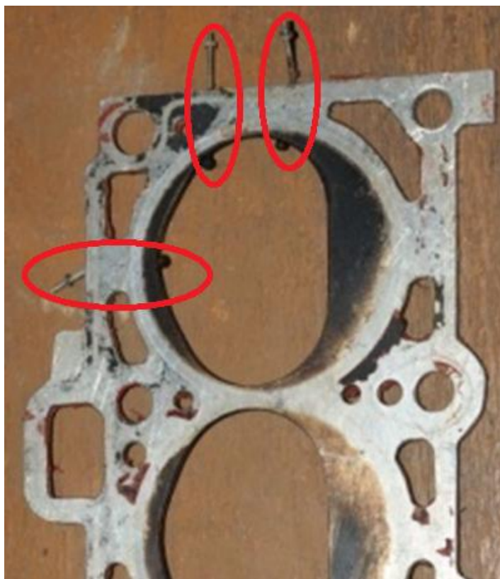
Рисунок 2.7 – Общий вид датчиков для исследования электропроводности пламени, в двигателе ВАЗ-2111: алюминиевые датчики в специальной пластине.
