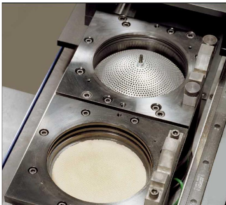
Рисунок 1.9 – Схема движения вихревого воздушного заряда через выпрямитель Типпельмана Рисунок 1.10 – выпрямитель Типпельмана на стенде AVL
