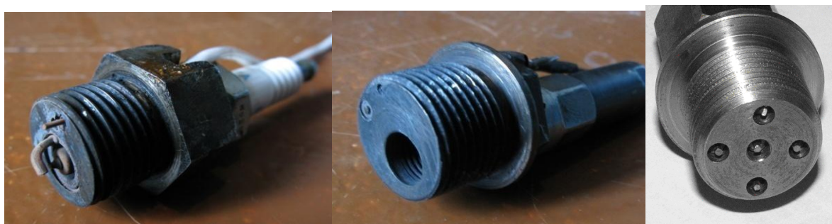
Рисунок 2.4 – Общий вид датчиков для исследования электропроводности пламени в УИТ-85: а) медный электрод у свечи зажигания; б) стальной электрод в переходнике с датчиком давления; в) пять стальных электродов в одном корпусе.
