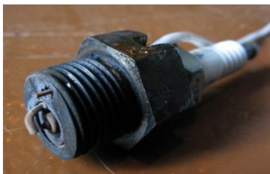
Рисунок 3.2 – Применяемые датчики ионизации: (а) датчик ионизации 1, установленный рядом со свечей зажигания; (б) датчик ионизации 2, установленный рядом с датчиком давления ДМВГ-50
