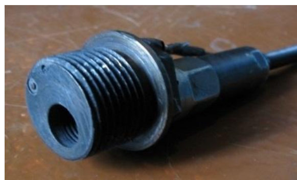
Рисунок 3.2 – Применяемые датчики ионизации: (а) датчик ионизации 1, установленный рядом со свечей зажигания; (б) датчик ионизации 2, установленный рядом с датчиком давления ДМВГ-50
