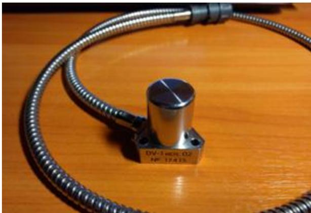
Рисунок 5– Внешний вид датчика DV-1 (исп. 02) с антивибрационным кабелем в металлическом рукаве
