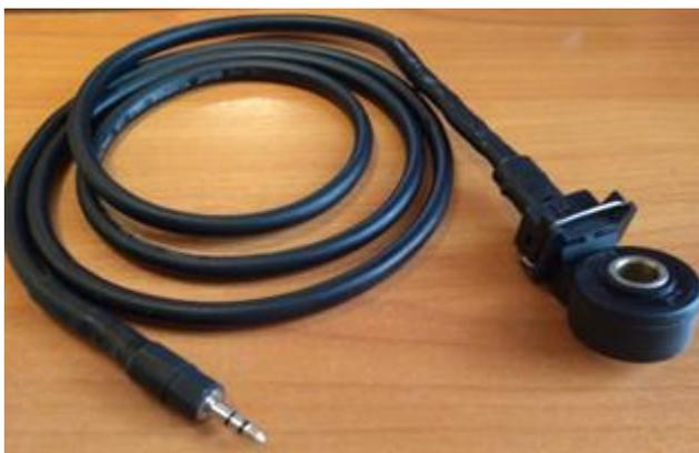
Рисунок 2 Датчик детонации с микрофонным кабелем
