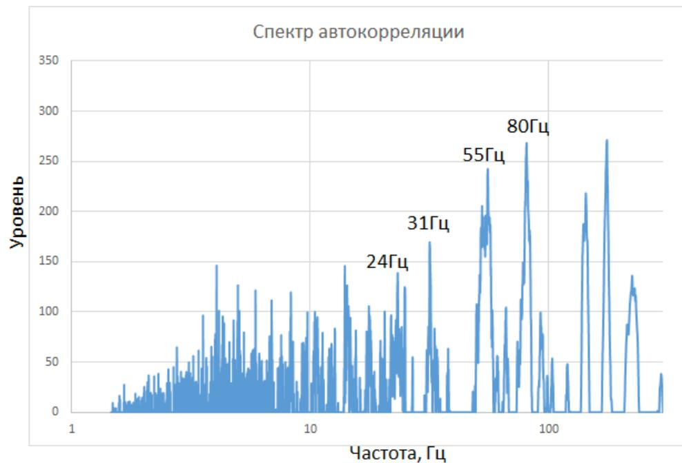
Рисунок 44 – Автокорреляция сигнала точки №1 на подшипнике входного вала (ВАИК)
