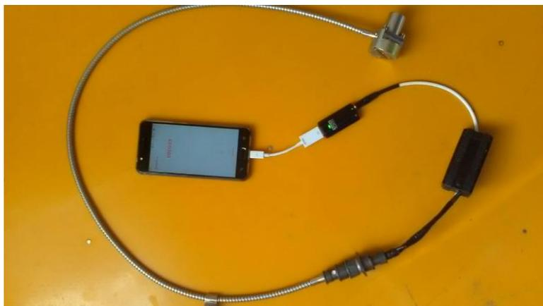
Рисунок 23 – Виброакустический измерительный канал
