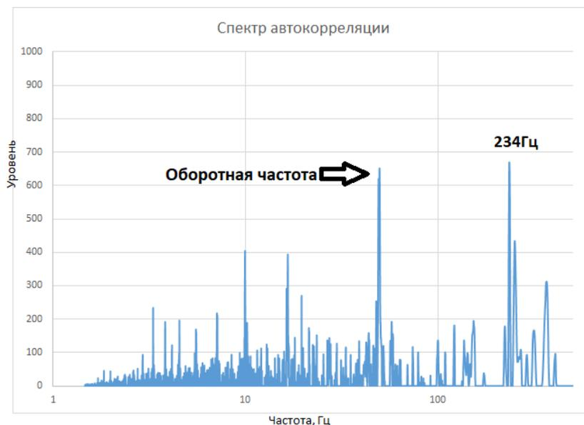
Рисунок 36 – Спектр автокорреляции сигнала от переднего подшипника двигателя (ВАИК)
