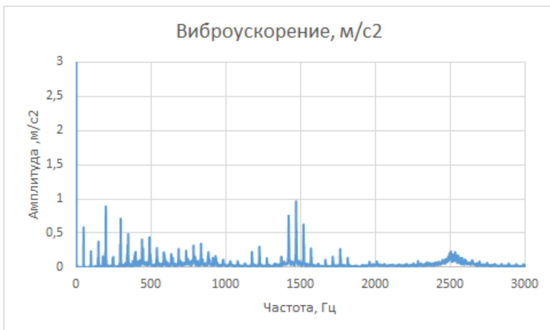
Рисунок 33 – Спектр виброускорения сигнала от переднего подшипника насоса (ВАИК)
