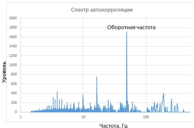
Рисунок 37 – Спектр автокорреляции сигнала от переднего подшипника насоса (ВАИК)
