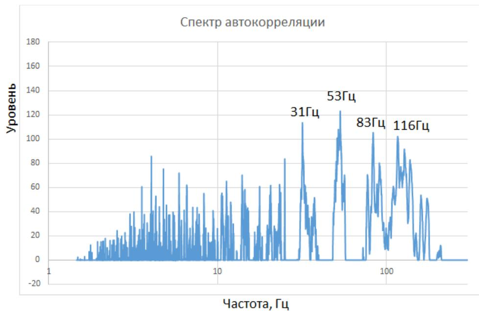
Рисунок 42 – Автокорреляция сигнала точки №6 на подшипнике выходного вала (ВАИК)
