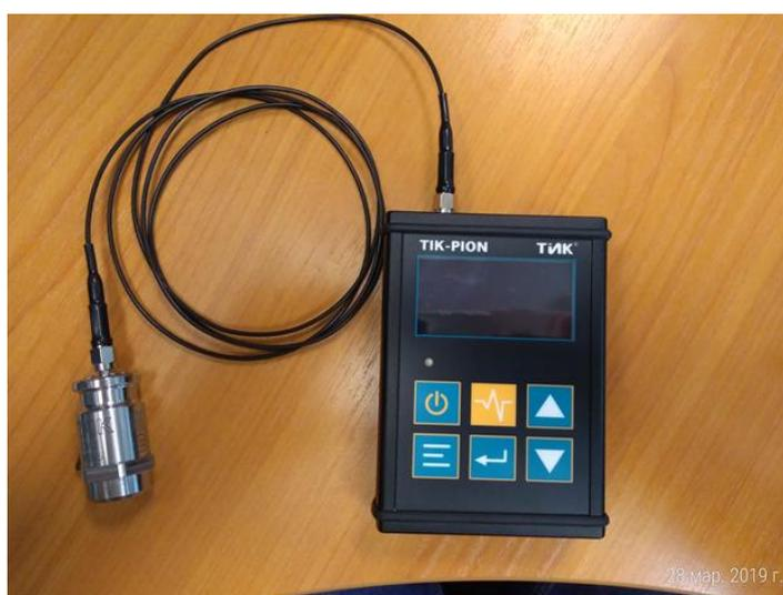
Рисунок 17– Виброметр «ТИК-ПИОН».
