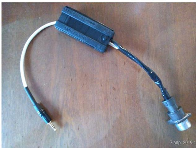
Рисунок 10– Разъём-переходник с батарейками для питания усилителя в датчике DV-1
